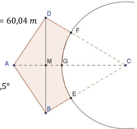
2.3.  $U_{\text{umfang}} = \overline{AB} + \overline{AD} + \overline{BE} + \overline{DF} + \text{Kreisbogen } \widehat{FCE}$
